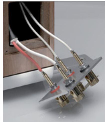
Die Bi-Wiring-Terminals sind auch im Innern einzeln angeschlossen
