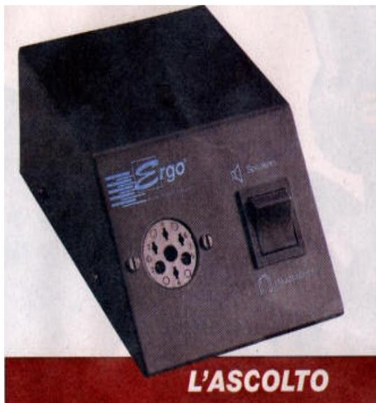
La Ergo AMT va collegata alle uscite di potenza dell'amplificatore; la commutazione tra questa e i diffusori si effettua per mezzo dell'interruttore disposto sull'adattatore a corredo.
